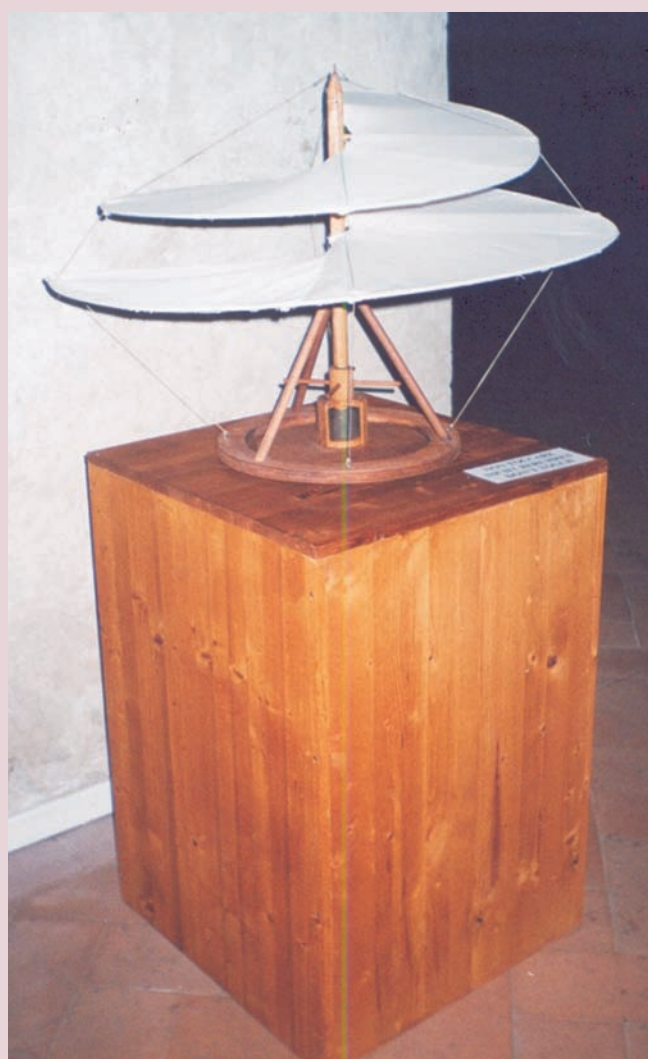
Antecedente del helicóptero, en el cual el giro de la espiral, accionada por cuatro hombres, lograría su despegue del suelo en unos escasos metros.
