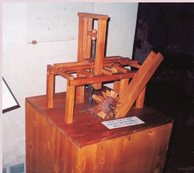
Sierra accionada por rueda movida por una corriente hidráulica.
