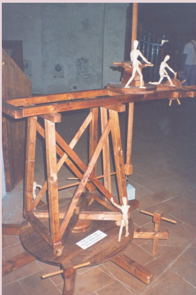
Gran grúa basada en las diseñadas por el arquitecto Brunelleschi para la construcción la cúpula de la catedral de Florencia.
