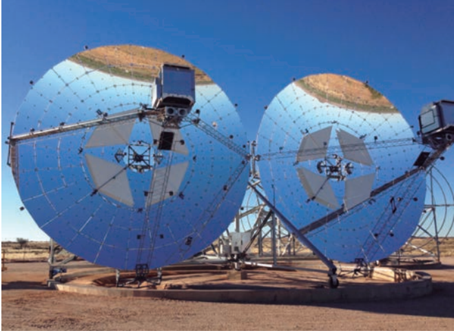
U 200901617. Estructura regulable para reflector parabólico
