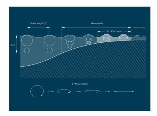
Nuestro panel está fijado al fondo marino, y se balancea hacia adelante y hacia atrás con el fenómeno de la oleada. Y es una forma muy eficiente de extraer energía, porque estás atrapando toda la columna de agua y extrayendo energía de este gran volumen de agua que se mueve hacia adelante y hacia atrás, y el panel en realidad no se mueve a través del agua, solo se mueve con el agua: la oleada lo empuja hacia atrás y hacia adelante.
