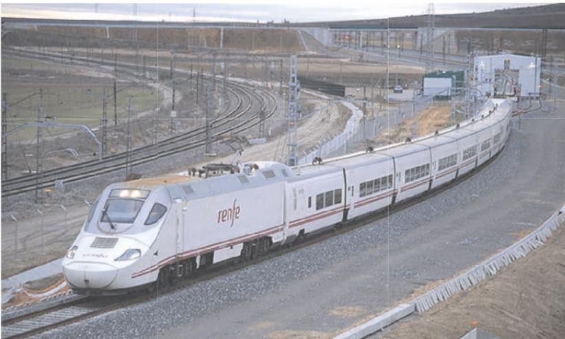
A la izquierda un Alvia S-130 acaba de salir de un cambiador de ancho. Abajo a la derecha un Alvia S-120 en pleno proceso de cambio de ancho.
