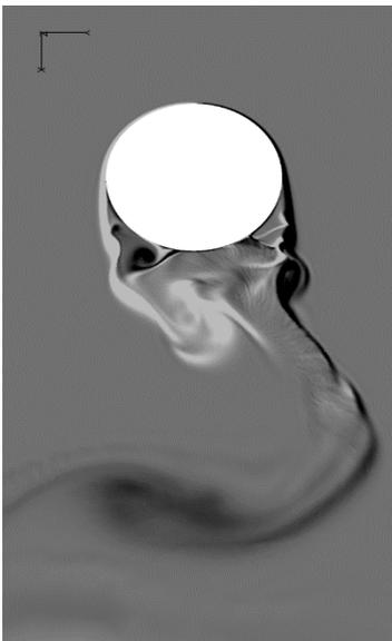
Su tecnología está basada en la **resonancia aeroelástica** lo que permite que se aproveche el fenómeno de aparición de vórtices.
