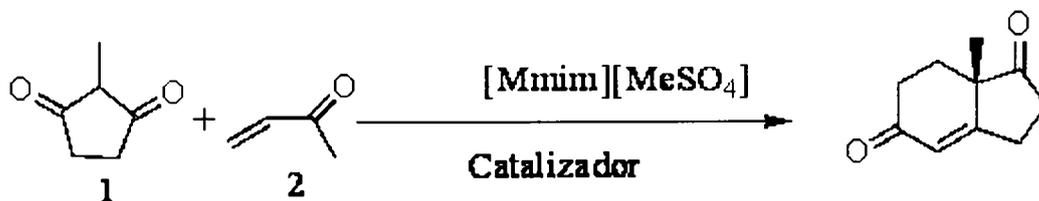
20 En detalle, el procedimiento más preferible de la invención comprende la obtención de la tricetona 3 utilizando [Mmim][MeSO<sub>4</sub>] como disolvente y catalizador de la reacción, y la obtención posterior de la diona a partir de la tricetona 3 sirviendo la L-Prolina como catalizador que posteriormente se recupera. Todos los reactivos se incorporan a la reacción al comienzo de la misma, no necesitando el procedimiento ningún aporte suplementario hasta la obtención del producto final.
