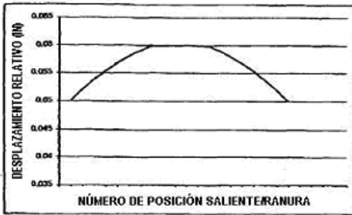
(a) Desplazamiento radial relativo bajo presión de inyección de rotura
