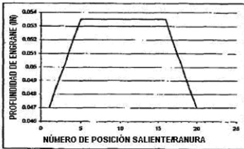
(b) Aplicación radial nominal del diente en función de la posición
