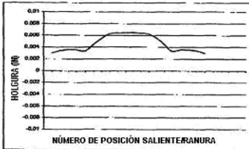
(c) Holgura radial durante el desmontaje (caso efectivo 2(a) - Caso 2(b))
