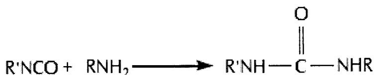
Figura 1. Reacciones entre el prepolímero reactivo de isocianato y el agua.
