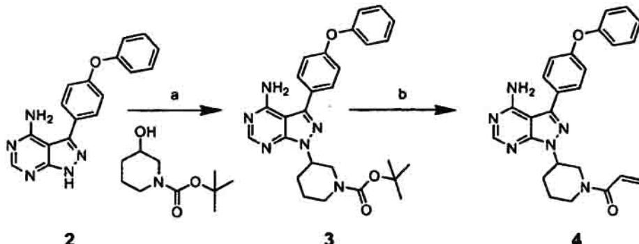
Síntesis del compuesto 4; a) trifenilfosfina (TPP) unida a polímero, diazodicarboxilato de diisopropilo (DIAD), tetrahidrofurano (THF); b) HCl/dioxano y entonces cloruro de acriloilo, trietilamina (TEA).
