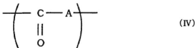
(en la que, A representa un resto derivado de un compuesto insaturado polimerizado a través de enlaces insaturados y puede ser el mismo o diferentes en cada unidad repetitiva). En particular, se prefiere policetona, de la que el 97% en moles o más de las unidades repetitivas es 1-oxotrimetileno [-CH<sub>2</sub>-CH<sub>2</sub>-CO-], más preferida es la policetona de la que el 99% en moles o más es 1-oxotrimetileno, y más preferida es la policetona de la que el 100% en moles es 1-oxotrimetileno.
