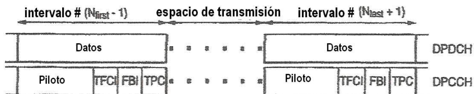
Estructura de trama en transmisión comprimida de enlace ascendente
