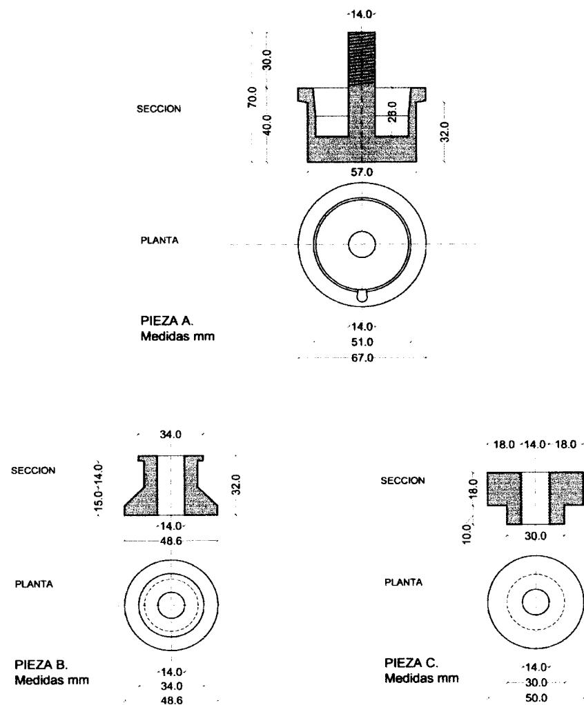
Figura 2 .- Características de la prensa de extracción de savia
