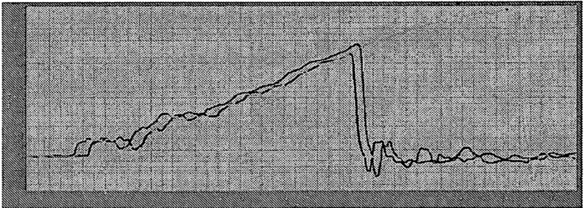
Figura 4: Material "CE2": Curva de impacto multiaxial a -30^{\circ}\text{C} , 6,6 m/s según la ASTM D3763. ( \varnothing 100 \times 3\text{mm} )
