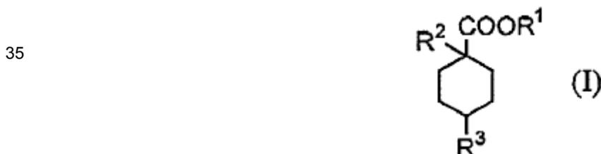
40 en la que R<sup>1</sup> y R<sup>2</sup> son cada uno independientemente un grupo hidrocarburo que tiene de 1 a 4 átomos de carbono, y R<sup>3</sup> es un grupo hidrocarburo que tiene de 2 a 4 átomos de carbono.
