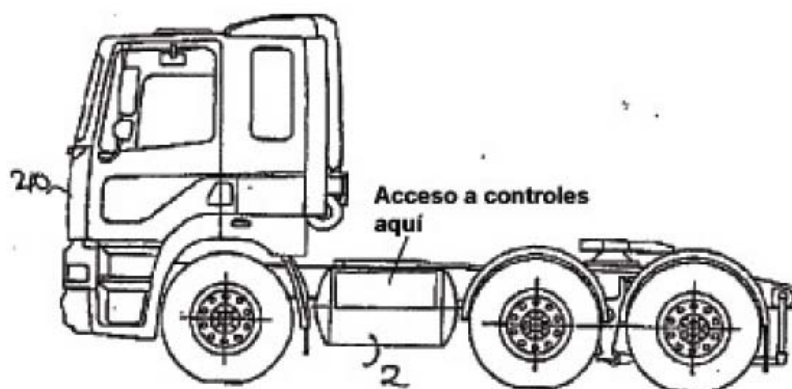
FORMATO TÍPICO DE NUEVO DEPÓSITO
