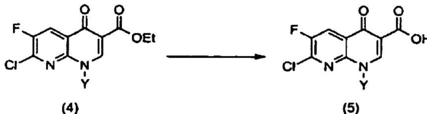
A la mezcla de reacción que contiene el compuesto (4) preparado en el paso de proceso c) se añade una disolución acuosa ácida. La mezcla se calienta para la hidrólisis del grupo éster y el cristal formado se filtra para obtener el compuesto (5).
