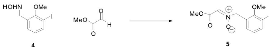
30 Una solución de hidroxilamina **4** (705 mg, 2,53 mmol, 1 equiv.) y glioxilato de metilo (445 mg, 5,05 mmol, 2 equiv.) en benceno (15 ml) se calentó a reflujo con un purgador Dean Stark durante una noche. El exceso de disolvente se retiró a presión reducida y la nitrona resultante **5** se recogió en bruto en la siguiente etapa.
