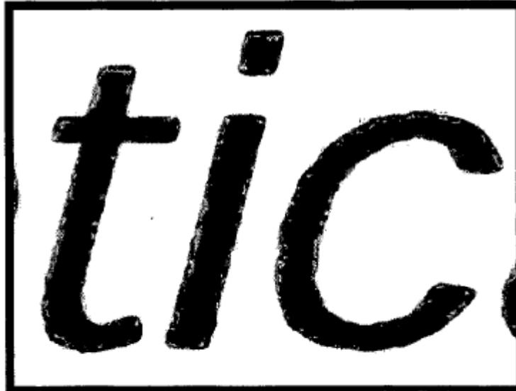
Imagen digital 6b: Tipo Helvetica de 4 puntos imprimido mediante la segunda placa flexográfica producida en el Ejemplo 8
