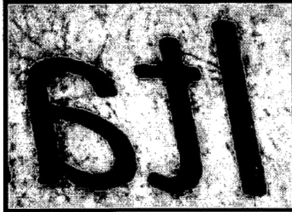
Imagen digital 8b: Tipo Helvetica de 4 puntos imprimido por la segunda placa flexográfica
