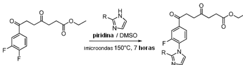
40 **Procedimiento representativo para el Esquema 36A: Síntesis de 7-(3-fluoro-4-(1H-imidazol-1-il)fenil)-4,7-dioxoheptanoato de etilo (R= H).** El 7-(3,4-difluorofenil)-4,7-dioxoheptanoato de etilo (351 mg) se trató con imidazol (241 mg) y piridina (395 mg) en DMSO (3 ml) a 150 °C durante 7 h con un calentamiento con microondas. La mezcla resultante se diluyó con agua (12 ml) y se extrajo con EtOAc (20 ml X 3). Después de retirar los disolventes, la
