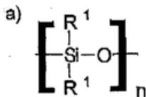
35  $R^1$  = independientemente entre sí alquilo  $C_1$ - $C_{30}$ , preferentemente alquilo  $C_1$ - $C_4$ , en particular metilo o etilo,  $n = 1$  a 5000, preferentemente de 10 a 2500, en particular de 100 a 1500.
