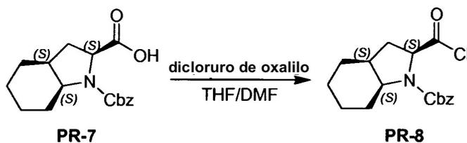
El compuesto **PR-7** (7,0 g, 23,21 mmol) en THF (70 ml) se agitó a 0°C. Se añadieron gota a gota dicloruro de oxalilo (7 ml, 46,2 mmol) y DMF (2 gotas) y la mezcla se agitó durante 10 min. a 0°C. La mezcla se agitó y se sometió a reflujo durante 1 hora. La mezcla se enfrió y se evaporó a vacío, dando como resultado el compuesto **PR-8** (7 g)
