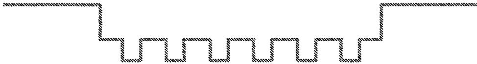
3. Si fuera necesario, depositar platino usando una máscara perforada para cubrir las áreas planas a izquierda y derecha. Cortar y liberar el diafragma.
