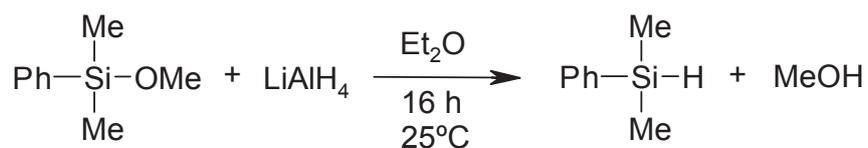
Se añade LiAlH<sub>4</sub> (79,9 mg, 2 mmol) sobre una disolución de PhMe<sub>2</sub>SiOMe (200 μl, 1 mmol) en dietiléter, y se agita la suspensión durante 16 horas a temperatura ambiente. A continuación, se neutraliza el exceso de LiAlH<sub>4</sub> mediante la adición de HCl 1M (10 ml), y se lleva a cabo una extracción con diclorometano. Posteriormente, el conjunto de fases orgánicas se lleva a sequedad, aislando así el silano PhMe<sub>2</sub>SiH (90% rendimiento).
