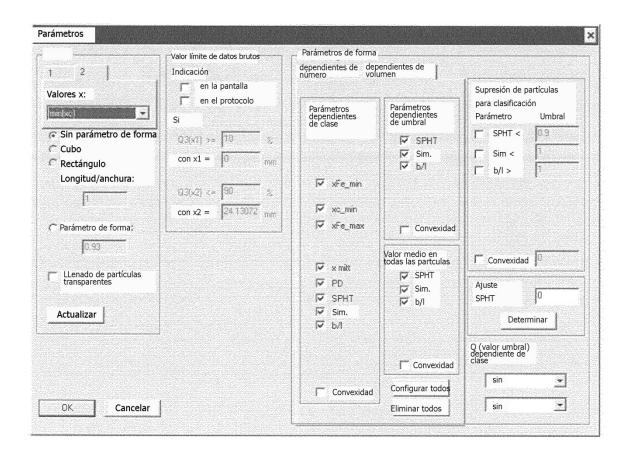
La función del valor  $d_{Q3=10\%}$  y del valor  $d_{Q3=90\%}$  se determina en los parámetros básicos:
