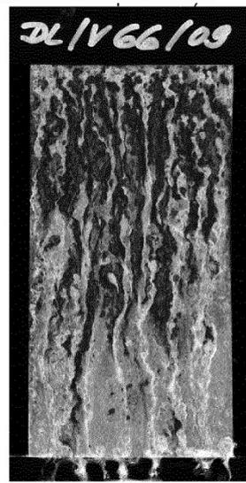
Figura 3: muestras del ejemplo 3 tras 181 h en niebla de pulverización salina
