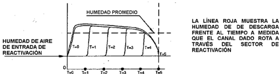
FIG. 5 - ONDA DE HUMEDAD QUE PASA A TRAVÉS DEL SECTOR DE REACTIVACIÓN DE LA RUEDA DESECANTE
