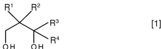
en la que  $\text{R}^1$ ,  $\text{R}^2$ ,  $\text{R}^3$  y  $\text{R}^4$  se seleccionan independientemente entre H y un radical alquilo C1-C6 lineal o ramificado, en una relación molar Ti:diol de entre 1:0,85 y 1:1,20, preferentemente de entre 1:0,95 y 1:1,05, en presencia de al menos un disolvente orgánico inmiscible con agua y posterior retirada de subproductos de reacción;
