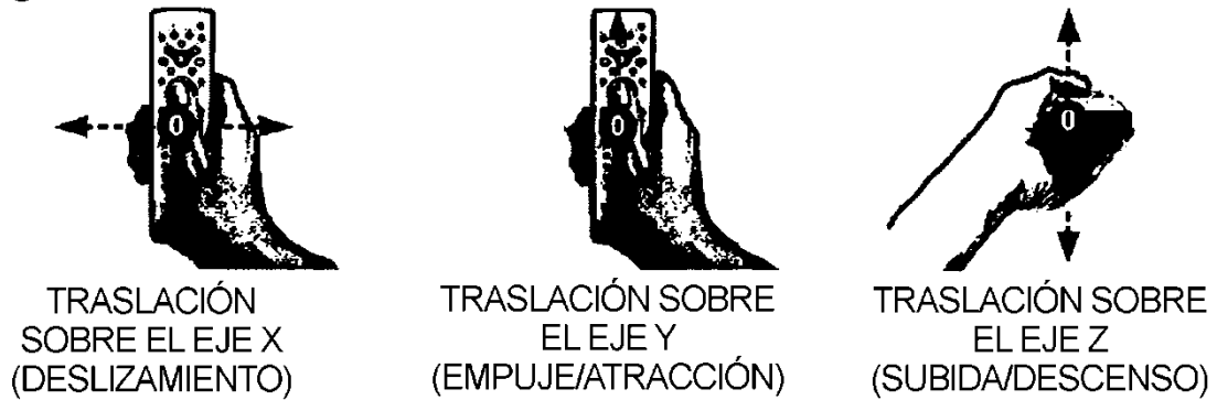
Fig. 1.3 - MOVIMIENTO DE TRASLACIÓN EN LAS DIERCCIONES X, Y, Z
