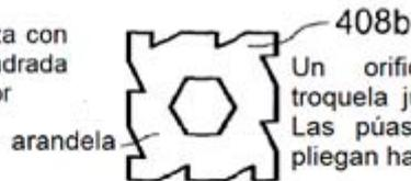
Un orificio redondo se troquea junto con las púas. Las púas se pinzan y se pliegan hacia abajo.
