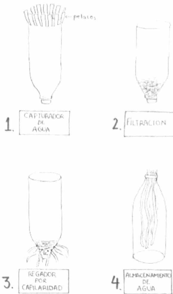
Figura 1.- Muestra una vista por módulo separados del dispositivo de la invención.
