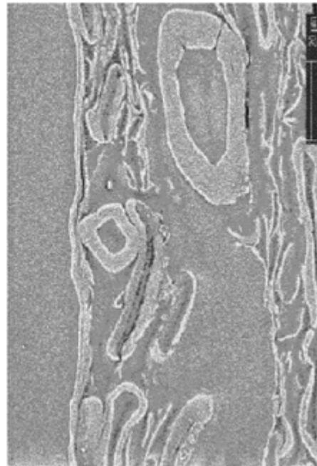
*c. BSE de una hoja recubierta con 2,1 g/m<sup>2</sup> de CMF*
