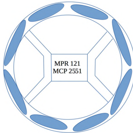
Fig. 1: Imagen esquemática del volante por la parte posterior, en la que se visualizan, en sombreado la posible ubicación de los electrodos de detección capacitivos o de otro tipo, los cuales estarán ubicados tras una protección de plástico, cuero u otro material, pudiendo quedar oculto a la vista del usuario. Se puede apreciar también la ubicación del chip de control capacitivo y del de conexión a CAN bus.
