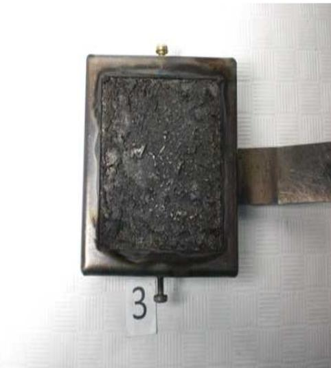
Figura 3 Altura de la capa intumescente formada después del ensayo del cono calorimétrico.
