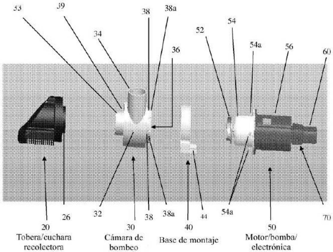
Figura 3: vista en despiece de una bomba de bajo perfil que tiene un diseño básico en cuatro partes.
