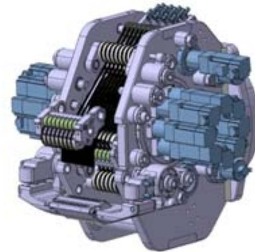
Las cintas en el cabezal AFP son guiadas a través de poleas individuales de rotación de baja inercia.
