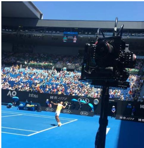
Cámaras 360° empleadas para la retransmisión, mediante realidad virtual, del Mutua Madrid Open 2018 (izquierda) y del Australia Open 2019 (derecha). Cortesía de YBVR.
