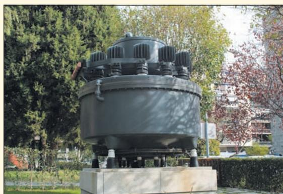
El estátor y el rotor que convertían el movimiento del motor en energía eléctrica tienen las dimensiones espectaculares que se aprecian en las fotografías de Rafael Zamorano. En cuanto a la regulación de la velocidad de giro, que debía mantenerse constante en las 150 r.p.m., se hacía mediante un pesado dispositivo mecánico, mucho más evolucionado que el clásico regulador de bolas de las primeras máquinas de vapor, pero muy lejos aún de la regulación electrónica actual.
