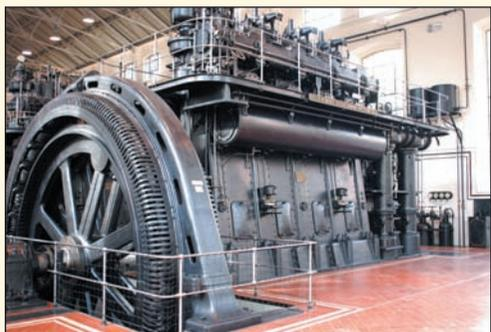
Cada uno de estos motores consta de cuatro cilindros principales, cuatro secundarios y un motor de arranque. Debido a las colosales dimensiones de la máquina, el motor de arranque se limita a generar aire comprimido para arrancar los cilindros secundarios, que, a su vez, hacen lo mismo con los cilindros principales. En total, el motor tardaba unos cinco minutos en entrar en régimen estable y empezar a suministrar energía eléctrica a la red del Metro.
