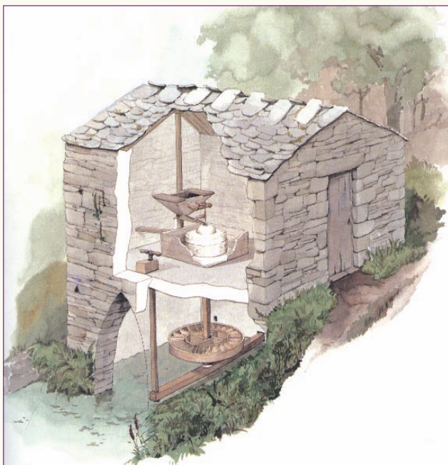
Molino harinero de rodezno con canal. En la imagen no se aprecia el canal, pero se ve el aliviador para calibrar la harina resultante al subir o bajar la muela corredera. Se trata de un dibujo que representa el conjunto monumental restaurado de Teixois (Asturias). Fuente: Javier López Linage y Juan Carlos Arbex 26 .
